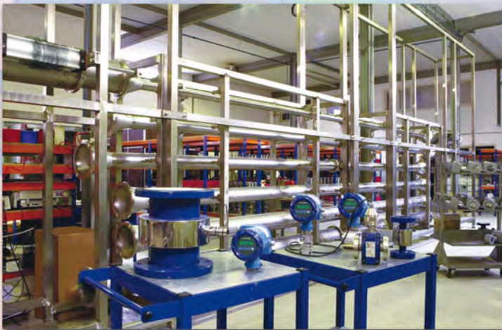
Bancos de calibrado para diámetros desde DN3 a DN150 Caudales hasta 200 m 3 /h de agua Caudales hasta 1000 Nm 3 /h de aire
