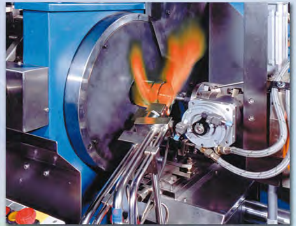
Acabado automático de los extremos de los tubos de vidrio borosilicato
