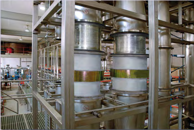
Bancos de calibrado para diámetros desde DN150 a DN1000 Caudales hasta 2000 m 3 /h de agua
